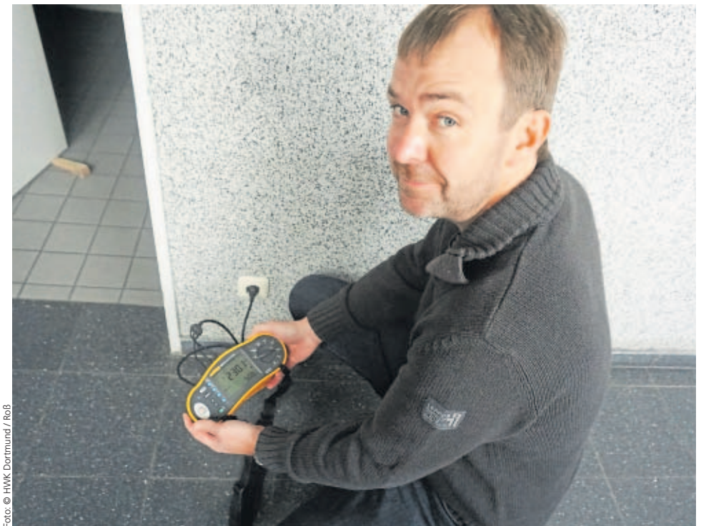
Andreas Beimdick überprüft mit Hilfe eines Messgeräts die Funktion der Schutzmaßnahmen an einer Steckdose.
