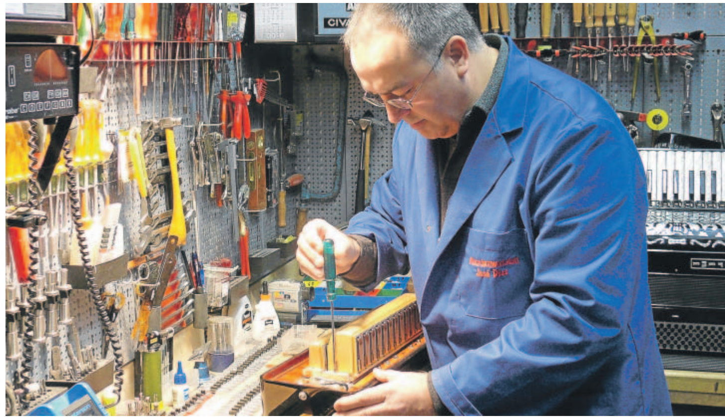
Hier ist Fingerspitzengefühl gefragt: José Dias baut die fertigen Stimmstöcke in das Akkordeon ein
